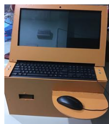
ภาพที่ 6 ตู้ระบบแปลงไฟล์ภาพและเสียงเป็นข้อความจําหน้าของจดหมายด้วยการประมวลผลภาพ
